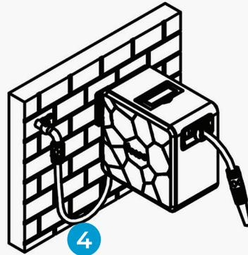
4 Conecte el conector del grifo a el grifo y conecte la entrada manguera y el adaptador de grifo.
