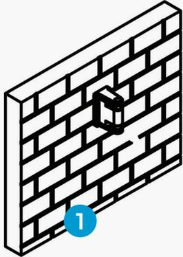
1 Elija una posición adecuada y marque la posición de los 4 agujeros en el muro con el soporte como guía.
