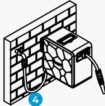
4 Conecte el conector del grifo a la entrada de manguera y el adaptador de grifo.
