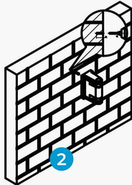
2 Perfore los 4 agujeros y ajuste el soporte al muro con los pernos proporcionados.
